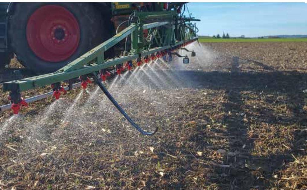
Extrem abdriftreduzierende Doppelfachstrahldüse XDT 130-04 mit symmetrischer 40° Doppelfachstrahl-Anwinkelung nach vorne/hinten. LECHLER GMBH
