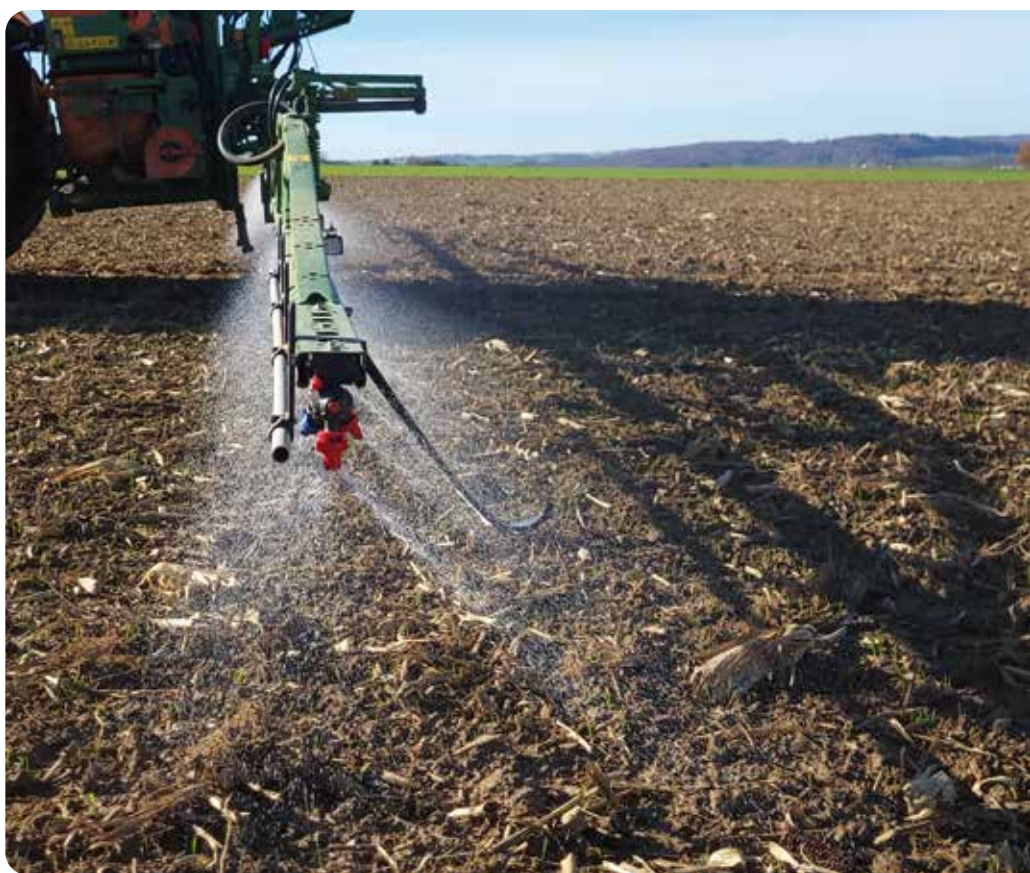
La buse à double jet plat et à double angle symétrique de 40° vers l'avant et l'arrière XDT 130-04 réduit massivement la dérive. LECHLER GMBH
