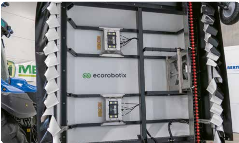
Neu sind die Kameras in einem abgeschlossen Kasten untergebracht, was sie weniger störungsanfällig macht. Les caméras se trouvent à présent dans un boîtier fermé ce qui les rend moins sujettes aux pannes. EP
