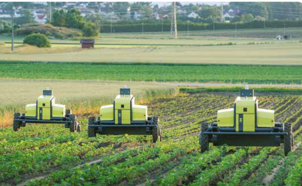
Eine Flotte mit den je rund 300 Kilogramm schweren autonomen Spritzroboter auf einem Gemüsfeld.
