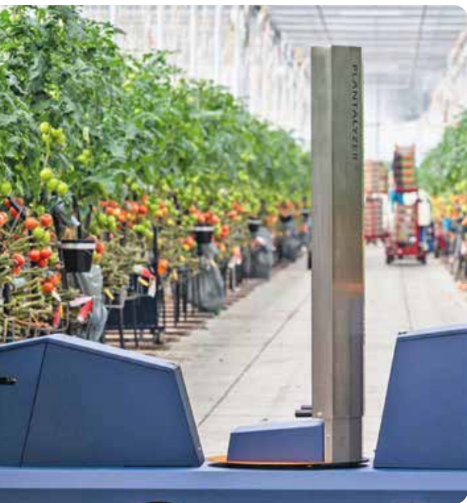
Der «Plantalyzer» überwacht den Reifegrad von Tomaten.
