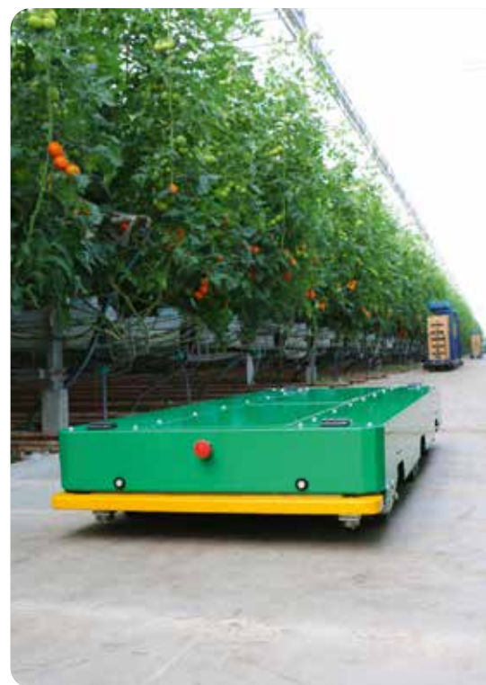
Das M-Flex-System von Metazet kommt ohne Induktionsverdrahtung aus.
